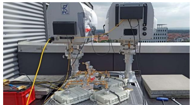
Komponenten einer THz-Punkt-zu-Punkt-Funkstrecke in Braunschweig (Quelle: TU Braunschweig)
