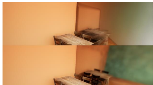
Abbildung 6: Eine Szene mit großer, reflektiver Fläche, wenn nur Screen Space Reflections benutzt werden (oben), und dieselbe Szene mit Lumen als Reflexionstechnik (unten).
