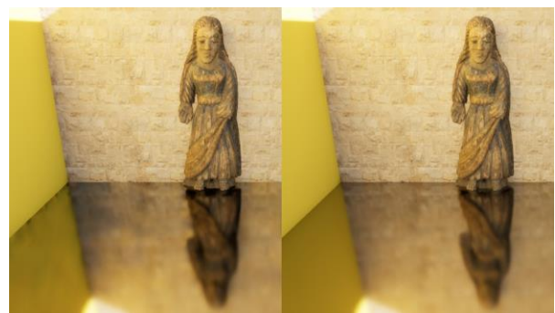
Abbildung 5: Eine Szene mit reflektivem Boden, wenn Lumen ohne Screen Space Reflections benutzt wird (links), und dieselbe Szene, wenn zu Lumen wieder Screen Space Reflections zugeschaltet werden (rechts).
